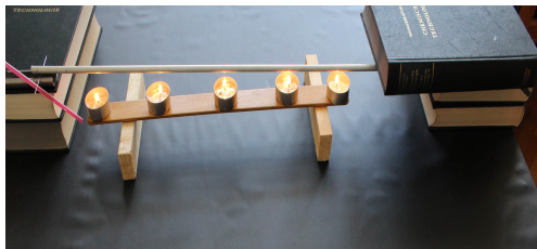
1.9.2 fényképek: szilárd test hőtágulása.
