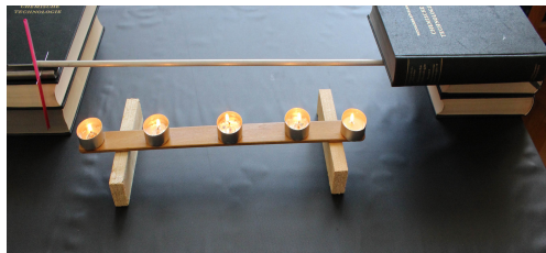
1.9.2 fényképek: szilárd test hőtágulása.
