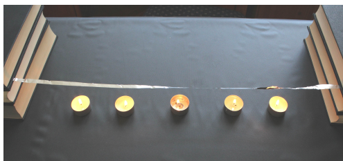
1.9.1 fényképek: alumínium csík belógása.
