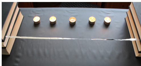
1.9.1 fényképek: alumínium csík belógása.
